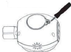
**STEP 2** Remplacer la batterie de type CR2032
